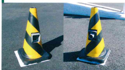
ミラー反射型で検出距離は4m
